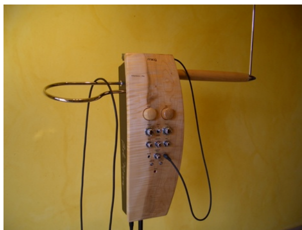
El cable encima de la antena horizontal provoca que no suene el theremin.
