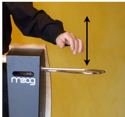
A nuestra izquierda tenemos la antena horizontal, con la que la mano izquierda se encargará de controlar el volumen del sonido.
