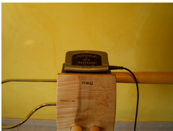
Indicador de afinación (afinador) conectado al theremin para visualizar las notas, incluso sin que el sonido del instrumento suene por el altavoz.
